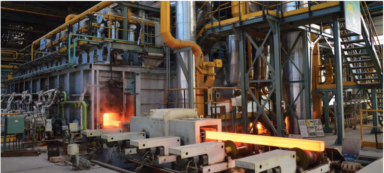
उपभोक्ता अनुरूप फ्री साइज़ रोलिंग युक्त स्ट्रेट लेंथ और कॉयल फॉर्म में 7.5 लाख प्रति वर्ष प्लेन राउंड्स उत्पादन क्षमता की विशेष बार मिल आरआईएनएल में चालू की गई
