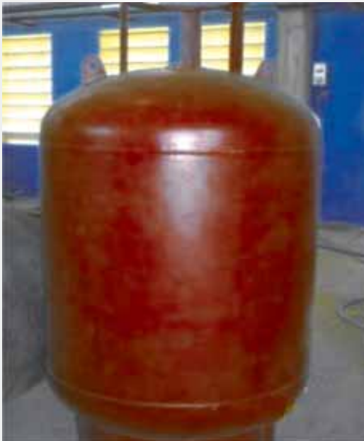
उच्च शक्ति इस्पात (ईएन 10028 पी 335एन) से निर्मित प्रोपेन गैस के लिए बड़ा सिलेण्डर (1000 लीटर क्षमता)
